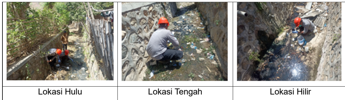
Gambar 3.29 Pengambilan Air Permukaan Drainase Primer Sambinae
