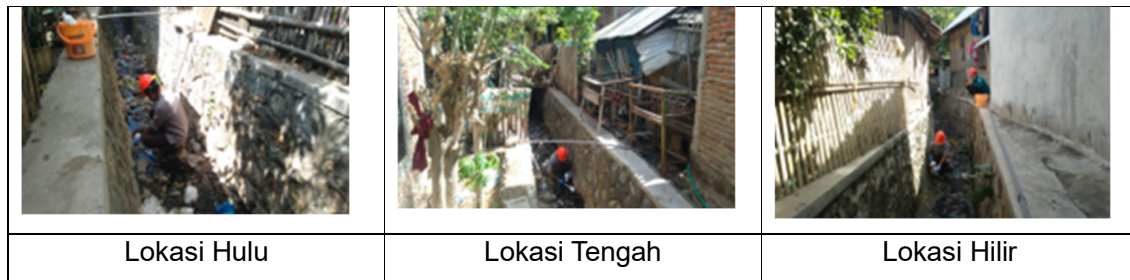
Gambar 3.28 Pengambilan Air Permukaan Drainase Primer Panggi
