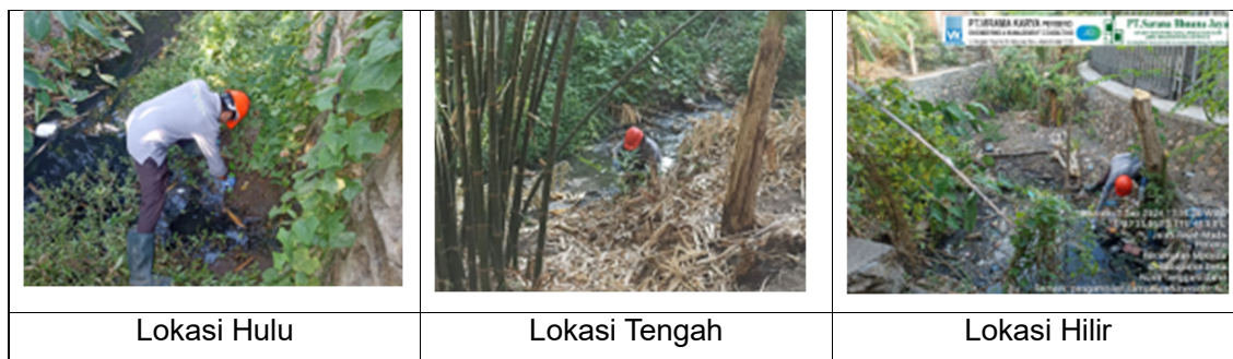
Gambar 3.32 Pengambilan Sampel Uji Sedimen Drainase Primer Penatoi-Santi
