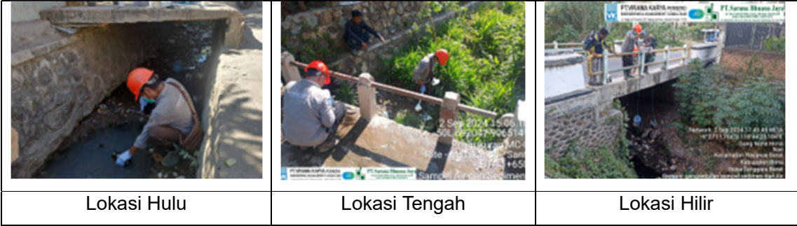
Gambar 3.24 Pengambilan Air Permukaan Drainase Primer Rite-Santi
